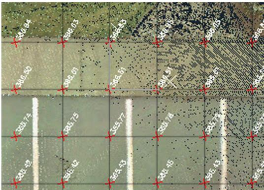
Die automatische Berechnung von Rasterpunkten und die SmartPick-Methoden sind Vermessungswerkzeuge um die Punktwolkendaten schnell in ein regelmäßiges DGM zu überführen oder mit intelligenter Unterstützung leicht zu digitalisieren.
