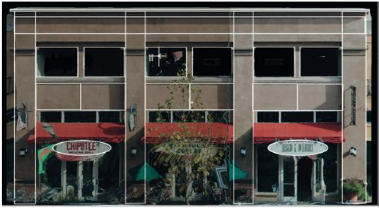
Das gängige Verfahren der Erstellung maßhaltiger 2D- oder 3D-Drahtmodelle anhand von Punktwolken, etwa zur Gebäuderenovierung oder für die Modellextrusion usw., wird durch verschiedene CloudWorx-Befehle vereinfacht.
